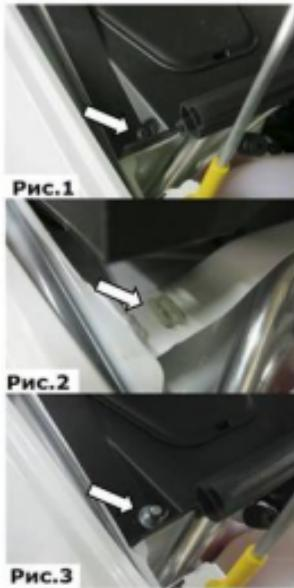
1. Ключом TORX 20 выкрутить саморез крепления жабо (Рис.1).
