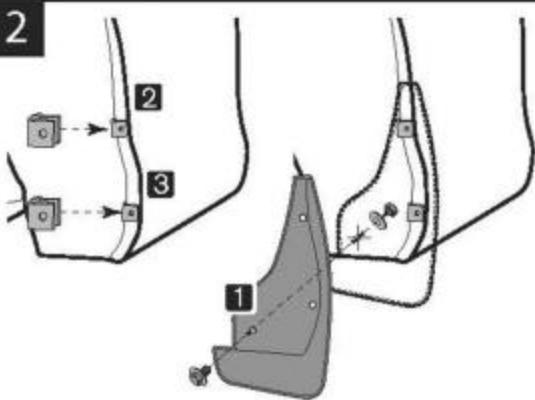
В точках 2 и 3 установите на кромку бампера крепежные скобы из комплекта поставки, в точке 1 установите болт, шайбу и гайку из комплекта поставки.
