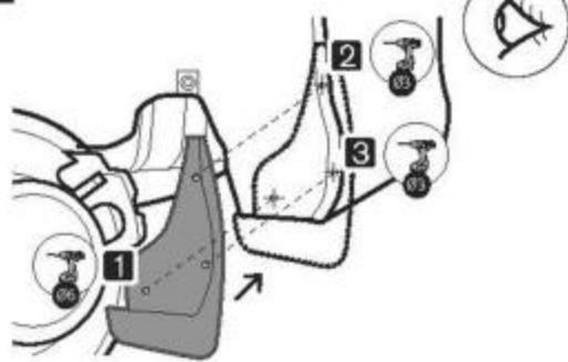
Проведите визуальную примерку изделия, приложив к планируемому месту монтажа. Согласно отверстиям на брызговике наметьте и просверлите отверстия.
