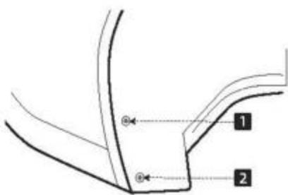
Используя шуруповерт с крестообразной насадкой, открутите два штатных самореза.
