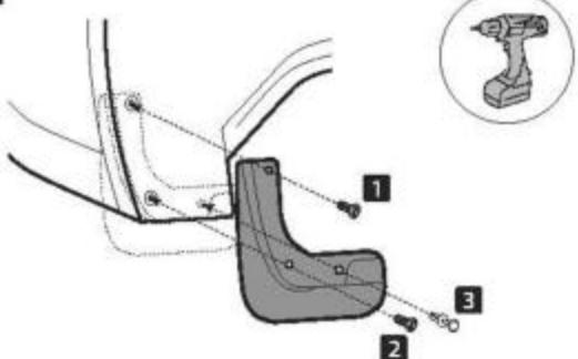
Используя шуруповерт с крестообразной насадкой, закрутите штатные саморезы в точках 1 и 2. Используя шуруповерт со сверлом Ø 8 мм просверлите отверстие в точке 3, установите пластиковый фиксатор из комплекта поставки.
