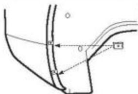
Установите монтажные скобы из комплекта поставки для дальнейшего монтажа самореза.
