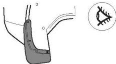
Используя шуруповерт с крестообразной насадкой, закрутите саморезы из комплекта поставки в точках 1 и 2. Используя шуруповерт со сверлом Ø 8 мм просверлите отверстие в точке 3, установите пластиковый фиксатор из комплекта поставки.
