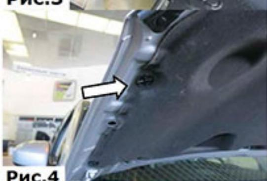
4. Удалить пистон крепления обшивки капота, (Рис.4).
