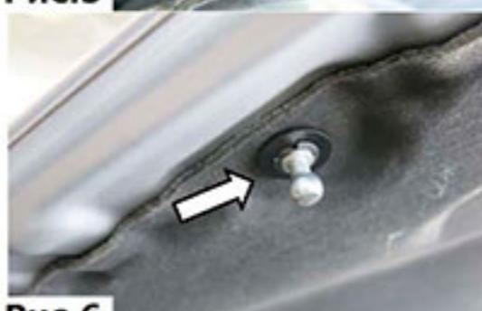
5. Прижать обшивку капота шайбой специальной. Зафиксировать шайбу специальную шайбой стопорной, (Рис.6).
