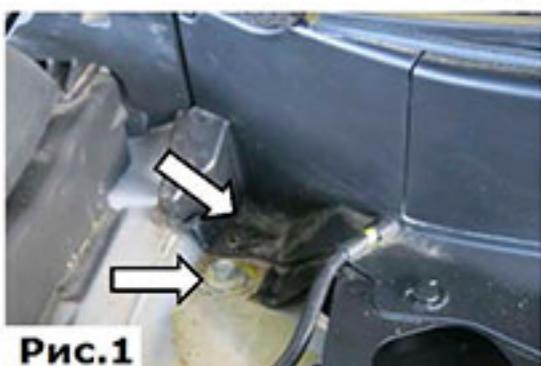
1. Торцевой головкой №13 открутить болт крепления опоры передней подвески. Удалить пистон фиксации пластика, (Рис.1).
