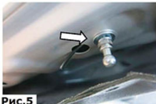
4. Завести планку закладную в отверстие в усилителе капота. Совместить резьбовое отверстие в планке закладной с отверстием от пистона. Вкрутить в планку закладную болт-шарнир с шайбой пружинной и шайбой. Затянуть шарнир высокой торцевой головкой №10 с усилием 6 Нм, (Рис.5).
