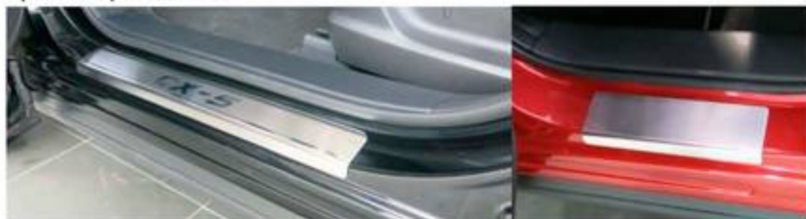
Фото установленных накладок
