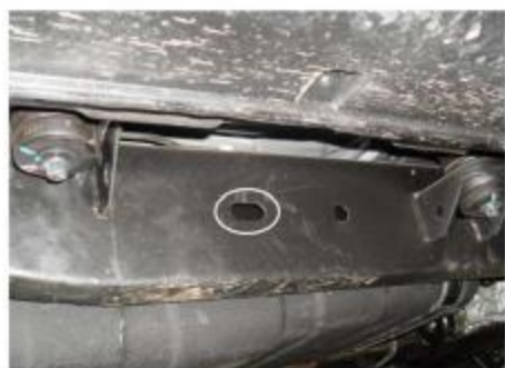
Рис. 6 Место крепления заднего кронштейна
