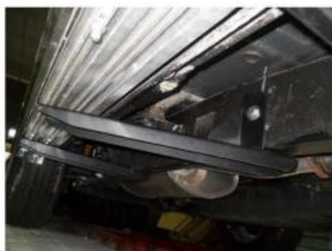
Рис. 8 Крепление среднего кронштейна
