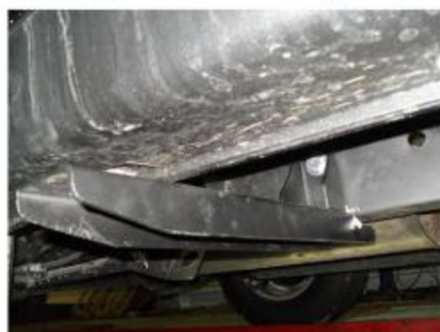
Рис. 9 Крепление заднего кронштейна
