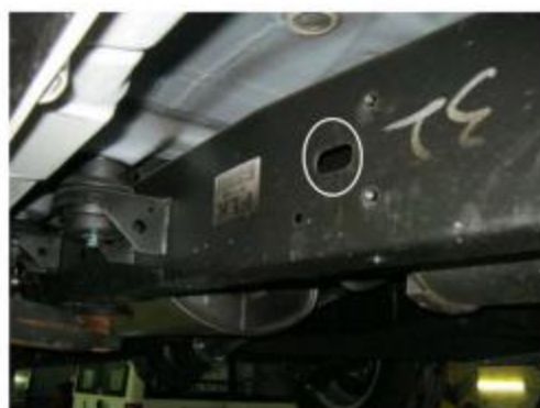
Рис. 5 Место крепления среднего кронштейна
