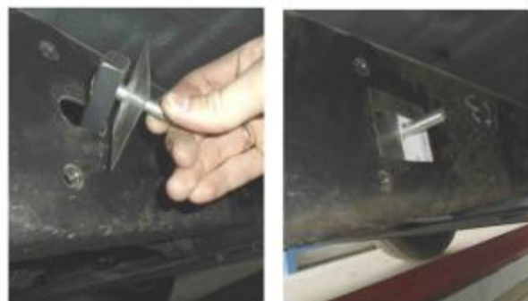
Рис. 7 Установка шпильки закладной М10
