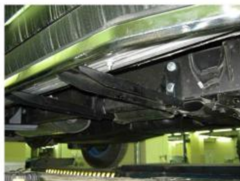
Рис. 3 Установка переднего кронштейна
