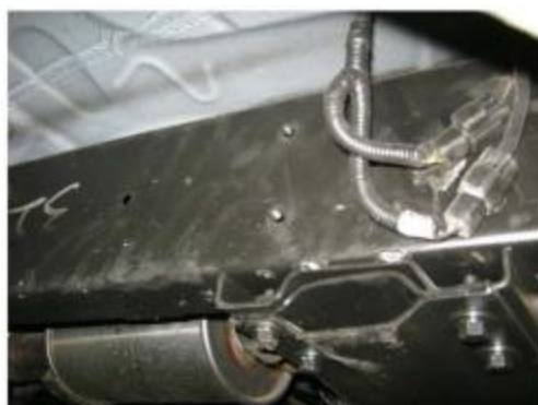
Рис. 2 Место крепления переднего кронштейна справа
