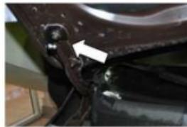
3. Открутить верхнюю гайку крепления капота. Установить кронштейн капота, уперев его в ребро жесткости. Затянуть гайку ключом №13 с усилием 23 Нм.
