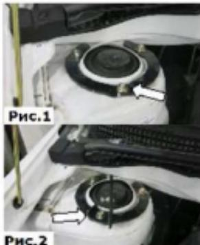
1. Торцевой головкой №13 открутить гайку крепления опоры передней подвески, (Рис.1).
