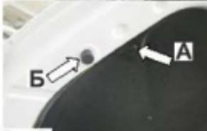
3. Демонтировать пистон (A) крепления обшивки капота. Выкрутить резиновый упор капота (Б) и запомнить количество оборотов, (Рис.3).
