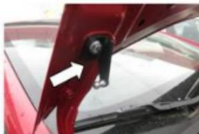
3. Открутить верхний болт крепления капота. Установить кронштейн капота, уперев его в ребро жесткости. Затянуть болт ключом №12 с усилием 23 Нм.
