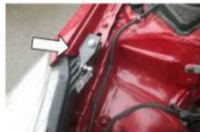
2. Установить кронштейн крыла, как показано на рисунке. Затянуть болт ключом №12 с усилием 23 Нм.
