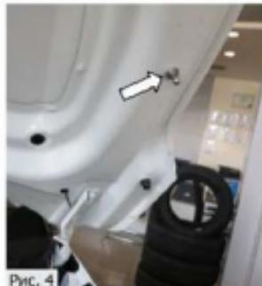
4. Вкрутить в планку закладную болт-шарнир с шайбой б пружинной, шайбой б и шайбой б пластиковой. Затянуть болт-шарнир торцевой головкой №10 с усилием 9 Нм, (Рис.4).
