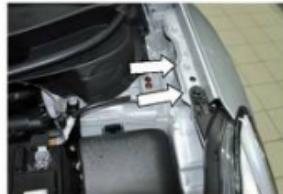
1. Открутить болт крепления фары и болт крепления крыла.
