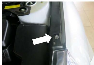
2. Установить болт-шарнир с шайбой как показано на рисунке. Затянуть болт ключом №10 с усилием 9 Нм.
