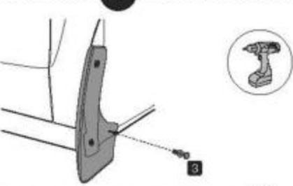
Используя шуруповерт со сверлом Ø 8 мм
