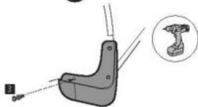
Используя шуруповерт со сверлом Ø 8 мм, просверлите отверстие в точке 3. Установите пластиковый фиксатор из комплекта поставки.
