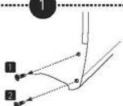
Используя шуруповерт, произведите демонтаж штатных саморезов в точках 1 и 2.
