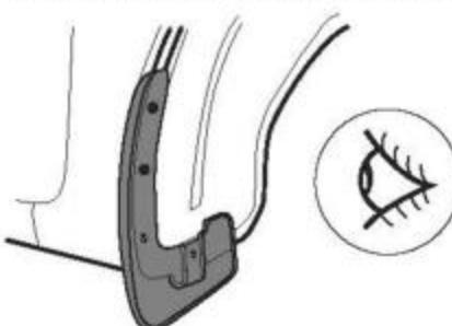
Установите пластиковые фиксаторы 2 и 3 из комплекта поставки, закрутите штатный саморез 1, закрутите саморез 4 из комплекта поставки.
