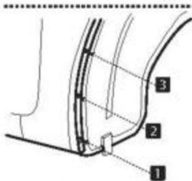
Открутите штатный саморез 1, извлеките штатные пластиковые фиксаторы 2 и 3.
