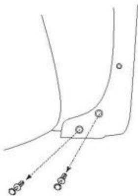
Произведите демонтаж штатных пластиковых фиксаторов.
