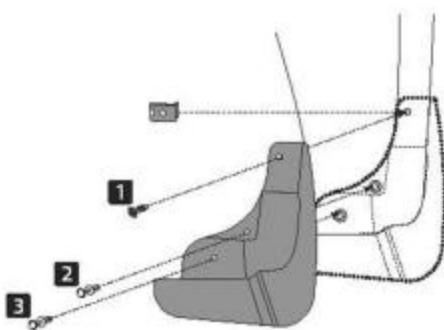
В точке 1 установите монтажную скобу и саморез из комплекта поставки. В точках 2 и 3 установите пластиковые фиксаторы из комплекта поставки.
